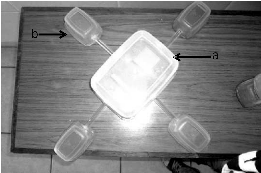
Figura 1. Sistema de opción múltiple empleado en la evaluación de preferencia alimenticia de Sitophilus oryzae . A: Sistema II; B: Sistema I.
