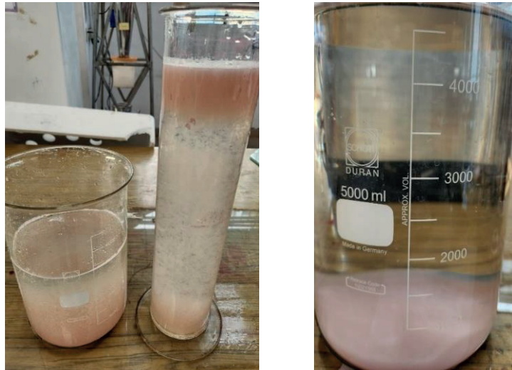
Figura 10. Proceso de decantación proveniente de la segunda electrocoagulación.
