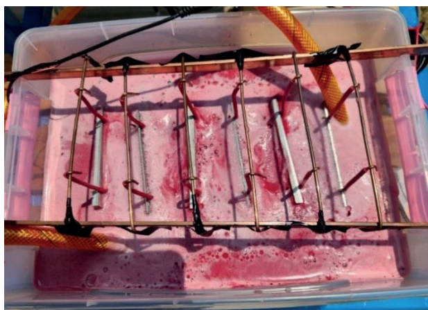
Figura 6. Proceso de electrocoagulación del colorante taicron-red 1g/L.
