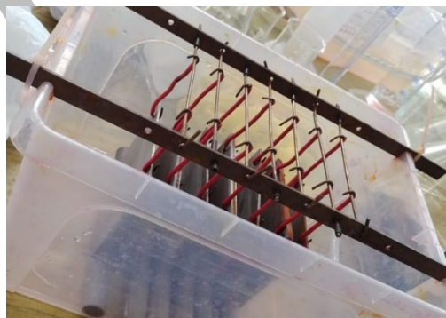
Figura 2. Celda electrolítica con cátodos de acero y ánodos de aluminio.
