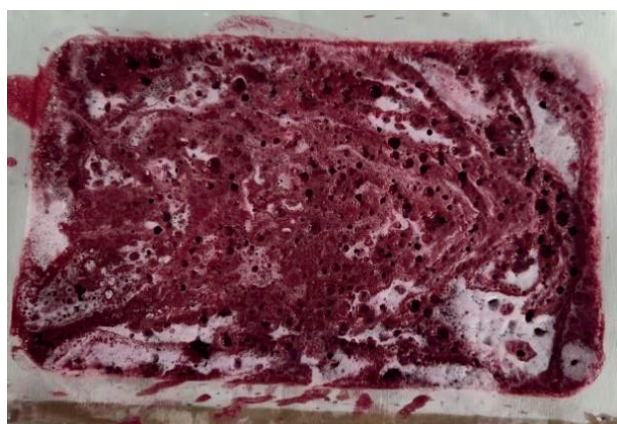
Figura 7. Floculo sobrenadante para su retiro manual.
