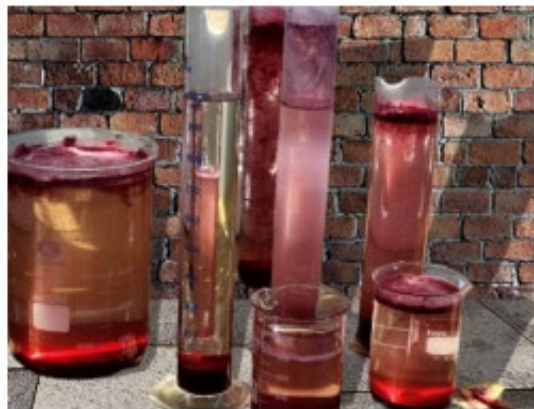
Figura 8. Proceso de decantación del flóculo (hidróxido de aluminio + colorante disperso).
