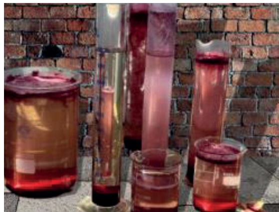
Figura 8. Proceso de decantación del floculo (hidróxido de aluminio + colorante disperso).
