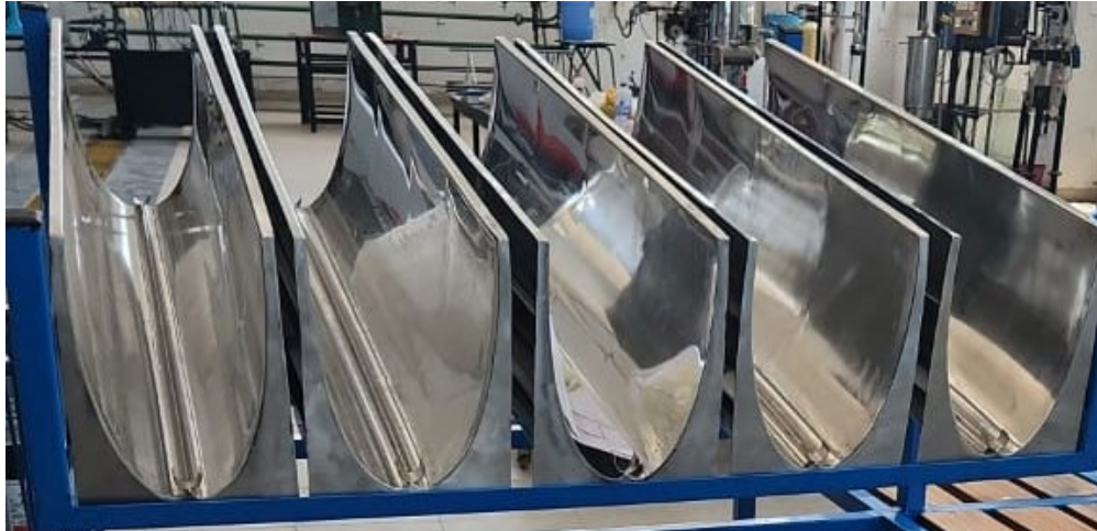
Figura 3. Fotorreactor de acero inoxidable brillante.
