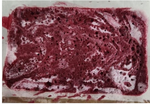
Figura 7. Flóculo sobrenadante para su retiro manual.
