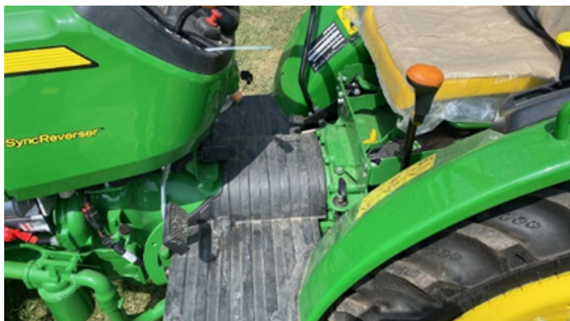
Figura 8 Tractor agrícola con semiplaforma, la carcasa del sistema de transmisión sobresale por debajo del asiento del operador
