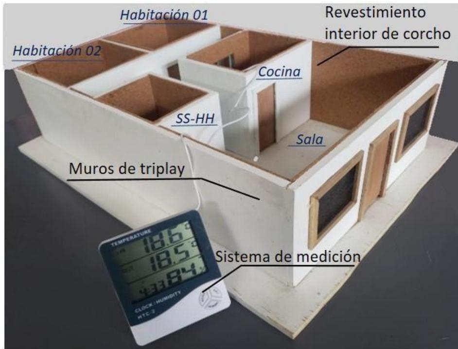
*Nota.* En la figura se muestra el prototipo P-1 a escala reducida revestido con corcho 2mm de la distribuidora N1 durante el registro de temperaturas. Además, se señala la distribución de espacios, mas no se visualiza el techo de la vivienda.
